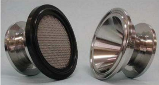
エレメント目開き:100 \mu (#150メッシュ) エレメント材質:SUS316L パッキン:パイトン
