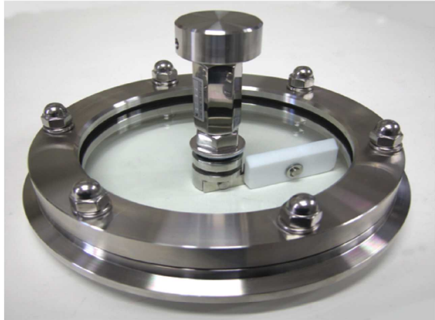
ワイパー付視窓:WWA-135-10 有効視径:φ125 仕上:機械加工肌 ヘルール:ISO-6. 5S(6S) 重量:約3kgf
