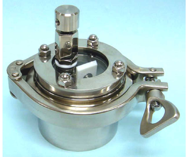
ワイパー付視窓:WWZ-055-8 有効視径:φ47 仕上:バフ研磨#400 溶接ヘルール(IDF3S)、高圧クランプ、パッキン付
