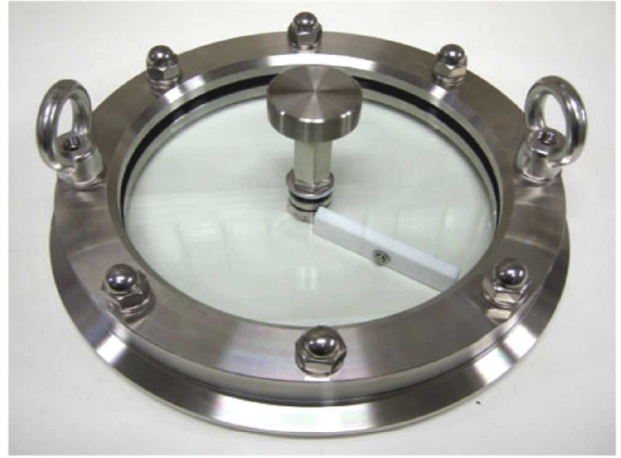
ワイパー付視窓:WWA-220-12 有効視径:φ203 仕上:機械加工肌 ヘルール:GAS-250A 重量:約9kgf
